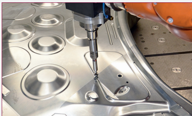
Kaltschmieden eines Serien-Ziehwerkzeugs mit FORGEfix® P auf einer Roboteranlage
