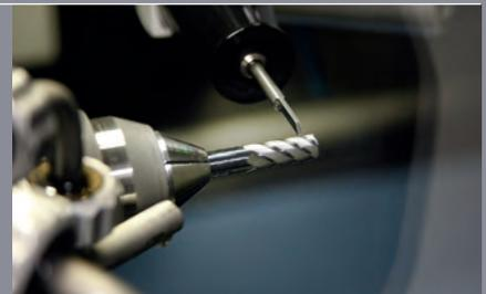
01 | Extrem genau im Grenzbereich: CNC-Schleifen
