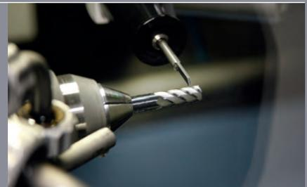
01 | Extrem genau im Grenzbereich: CNC-Schleifen
